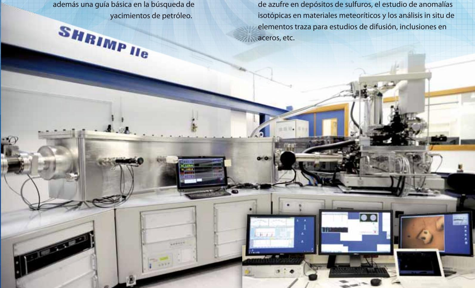
Además de estas aplicaciones, la SHRIMP permite determinar isótopos de Oxígeno con fines geológicos (procedencia de corteza o manto de las rocas a partir de los isótopos de oxígeno en circones), antropológicos (identificación de diferentes asentamientos humanos a partir de isótopos de Oxígeno en dientes), climatológicos (cálculo de paleotemperaturas de agua del mar a partir de la distribución de isótopos de Oxígeno en caparazones marinos).
